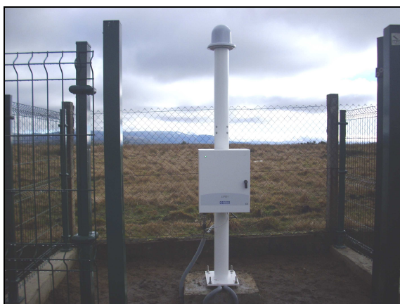
Fig.1: Detector de raios instalado na estación meteorolóxica de Alto do Rodicio e mapa de localizacións
