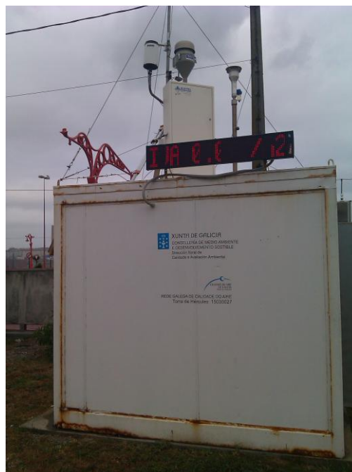
Figura 1. Captador gravimétrico Digitel DHA-80 na estación de fondo urbano da Coruña (Torre de Hércules)
