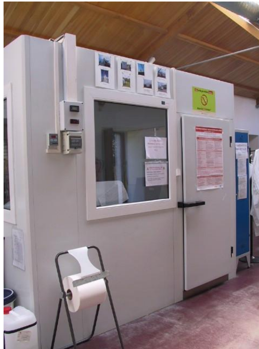
Figura 1. Sala de balanzas con temperatura e humidade controlada no IUMA (exterior)
