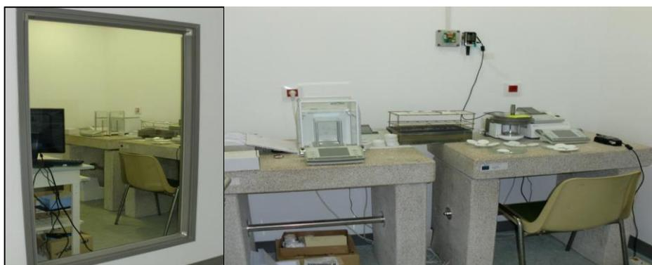
*Figura 1. Sala de balanzas do LMAG con temperatura e humidade controladas (exterior e interior).*
