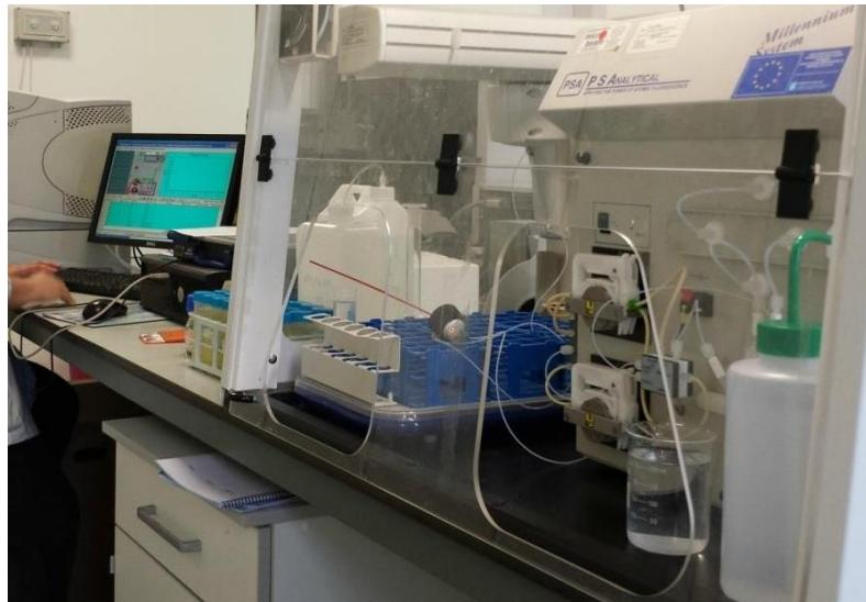
*Figura 2. Espectrometría de masas con plasma de acoplamento induutivo, LMAG.*
